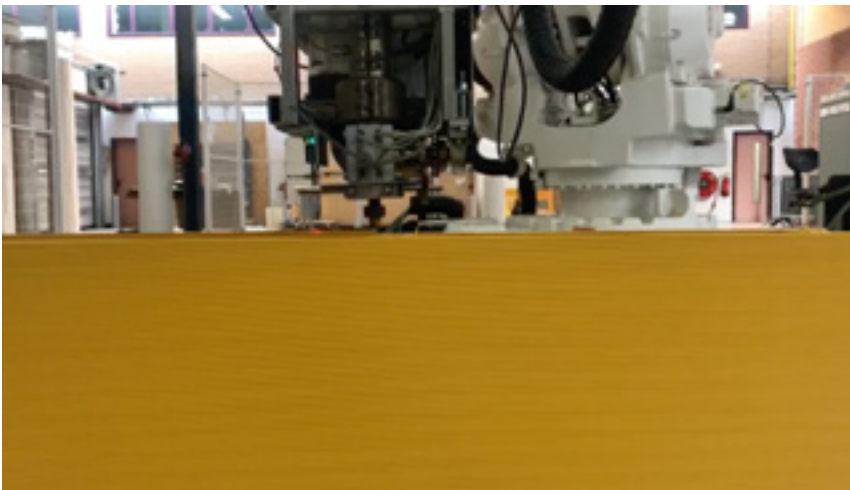
AFB. 16 Voor de mock-up werd een 3D-geprint paneel getest. Het bestaat grotendeels uit plantaardige grondstoffen die, na demontage van het paneel, tot zeven keer hergebruikt kunnen worden. De mock-up leerde evenwel dat 3D-printen een veelbelovende technologie is, maar dat dit specifieke paneel niet geschikt is voor buitentoepassingen (© Aectual).
