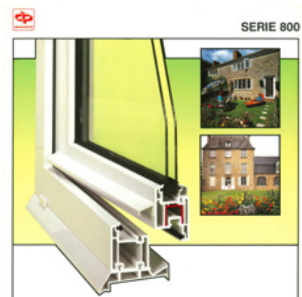
AFB. 11 PVC-raamprofielen hebben een belangrijke evolutie doorgemaakt vanaf het einde van de jaren 1960, met name op het gebied van thermische onderbrekingen en verstevigingselementen (in het rood aangeduid) (UCLouvain, BAIU-Bruxelles, documentbibliotheek. Productcatalogus van Deceuninck, 1986).
