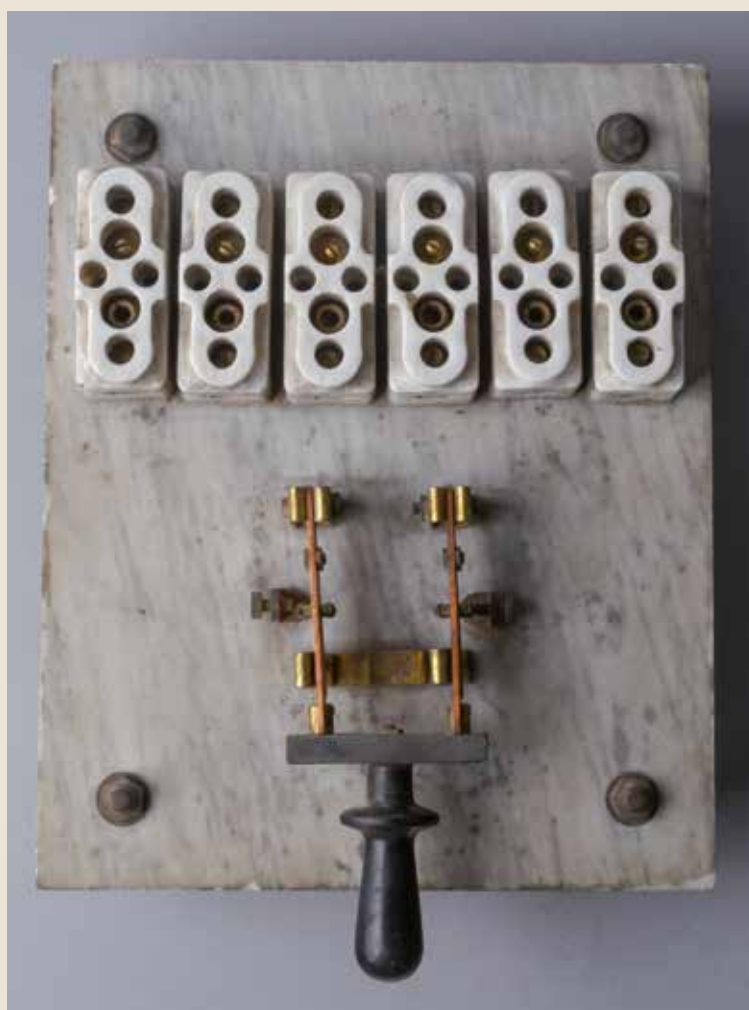
AFB. 1 Schakelbord met messchakelaar en zes porseleinen zekeringen (coll. Industriemuseum, V00020-001)
