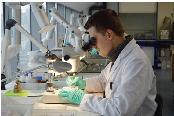
Afb. 10 Met behulp van een stereomicroscop kan de metaalrestaurateur het originele oppervlak zeer precies blootleggen (L. Cognard, KMKG, 2015 © GOB).
