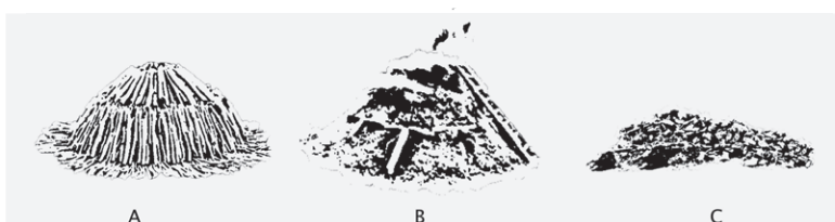
Afb. 6 reconstructietekening constructie meilers. A: het opstapelen van het hout. B: het afdekken van de meiler en het branden van de houtskool. C: recupereren van de houtskool. (© GOB/ULB).
