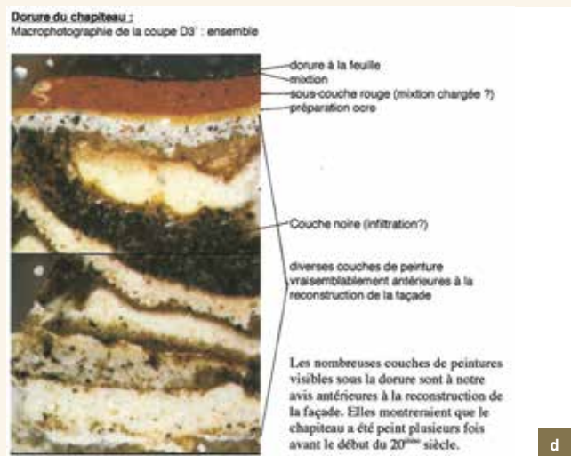
Den Ezel. a) stratigrafische analyse op een kapiteel (© M. Decroly, 2002); b) detail van het stratigrafisch onderzoek D2. 1. Steen. 2. Zwarte laag (poriënvulsel of zwarte korst). 3. Okerkleurige grondverf. 4. Rode onderlaag. 5. Verguldsel op hechtlaag (mixtion) (© M. Decroly, 2002); c) voluut van een kapiteel met monstername D3 (© M. Decroly, 2002); d) macrofotografie die de verschillende verflagen zichtbaar maakt en waaruit blijkt dat het kapiteel gerecupereerd zou zijn (© KIK-IRPA, 2002).
