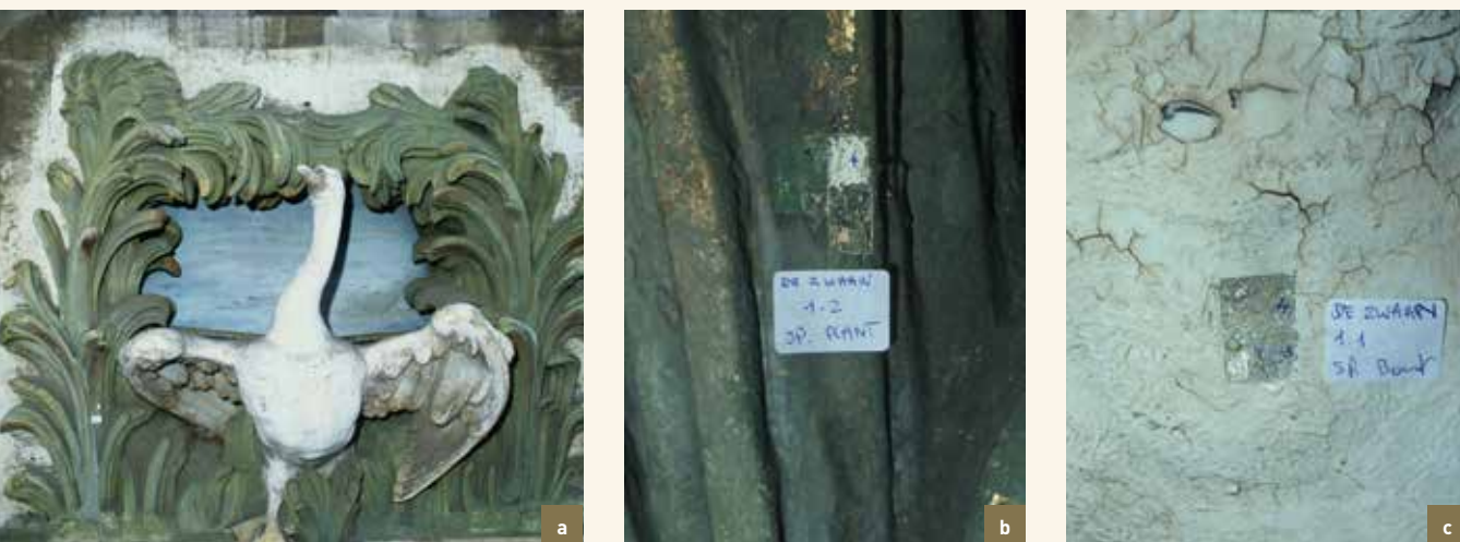
De Swane . Stratigrafische analyses van het beeld van de zwaan. a) totaalbeeld van de zwaan, met lokalisering van de kijkvensters; b) kijkvenster in het gebladerte; c) kijkvenster in het gevederte (© L. De Clercq, 2004).
