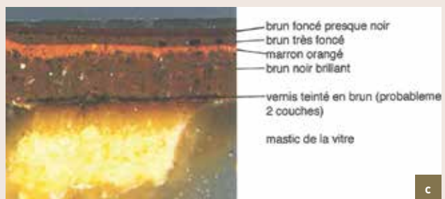
Den Ezel . a, b en c) stratigrafisch onderzoek en macrofotografie van een raamkozijn waaruit blijkt dat de oorspronkelijke laag een vernis was (a en b © M. Decroly, 2002 ; c) © KIK-IRPA, 2002).
