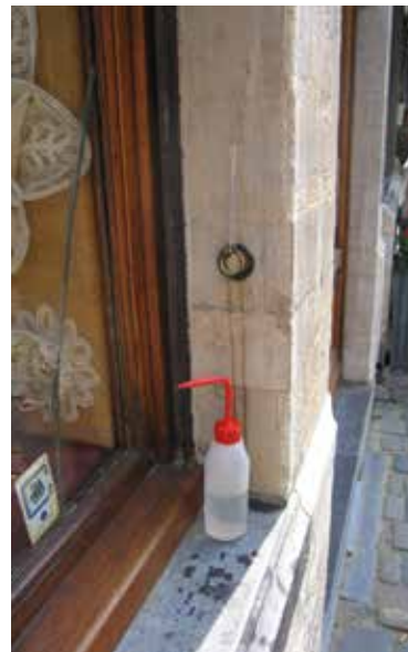
Den Ezel . Waterabsorptietest met Karstenpijp (© CHE, 2002).
