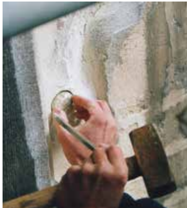
Den Ezel . Het nemen van een boormonster in de Balegemse steen (© CHE, 2002).
