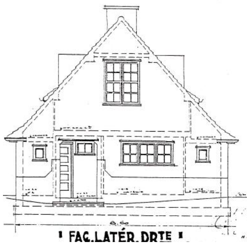
Plan Le Logis nr. 26: Zijgevel van huistype H&H1, J.J. Eggericx, (1922) en Foto P5040026 van het huis nr. 6 aan de Cyclamenstraat. Hier sluit de druiprand onmiddellijk aan op het portaal.
