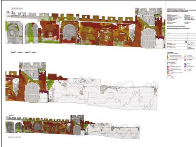
Cartographie des dégradations, façade intra-muros (dessin de l'auteur).
