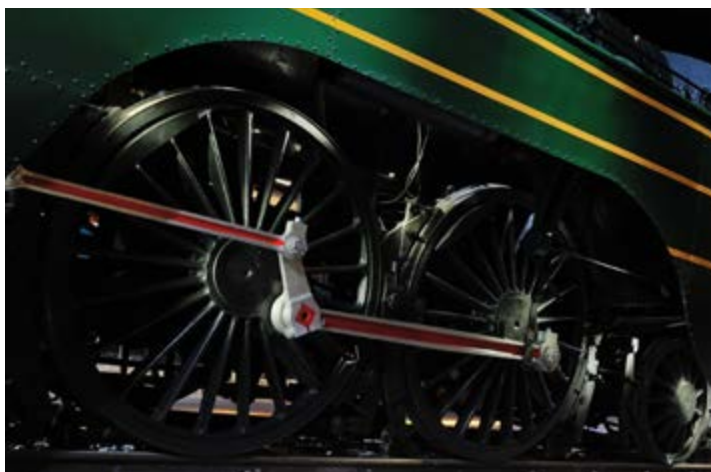
Les roues motrices de 2,10m (© Collection SNCB Train World Heritage).
