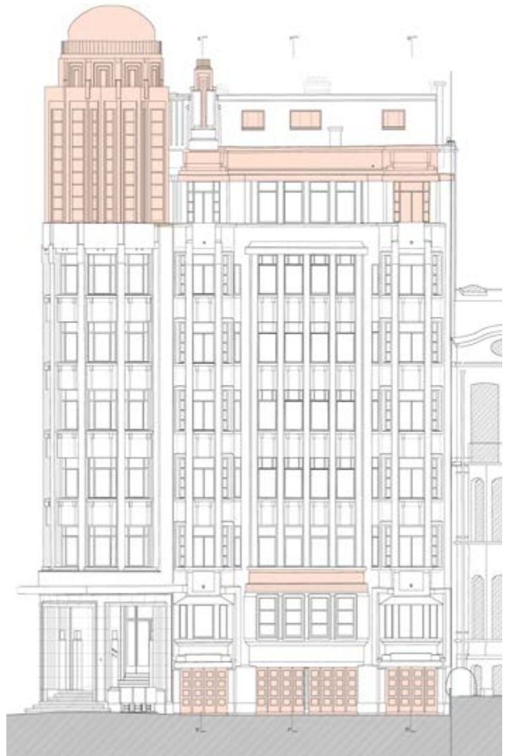
FIG. 4A Coupes façades 1928_2025 01 06, façade boulevard Général Jacques : hypothèse de restitution 1928 (© Barbara Van Der Wee architects).
