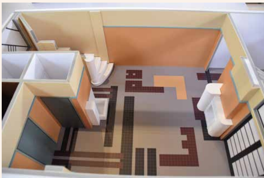
FIG. E.4.3 Rue de la Seconde Reine 5, Uccle, maquette du rez-de-chaussée illustrant la profusion des couleurs du décor d'origine démontrée par une étude stratigraphique (© ARCHistory, 2020).
