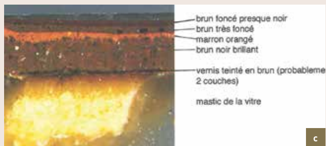
L'Âne . a, b et c) sondage stratigraphique et macrophotographie d'un châssis indiquant un vernis comme couche originale a et b) © M. Decroly, 2002 ; c) © KIK-IRPA, 2002).
