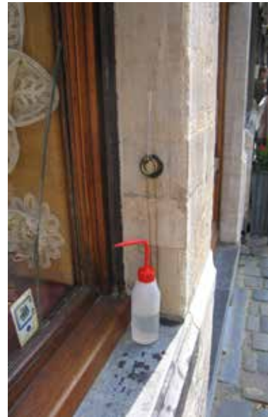
L'Âne. Essai d'absorption d'eau à la pipe Karsten (© CPH, 2002).
