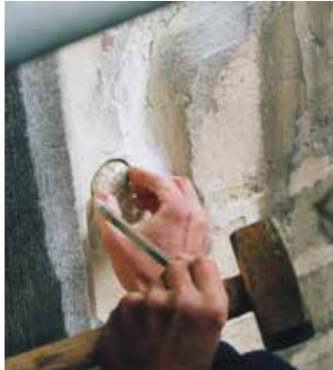
L'Âne. Carottage d'un échantillon de pierre de Balegem (© CPH, 2002).
