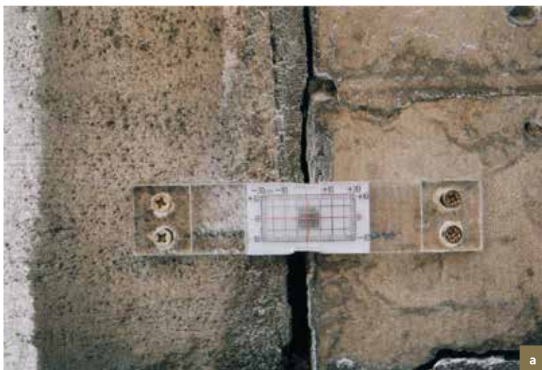
L'Âne . a) fissuromètre; b) relevé des mesures (© CPH, 2002).
