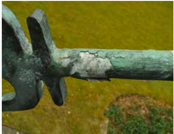
Fig. 11b Écaillage de la couche de cuivre sur le trident en aluminium (© Metafose).
