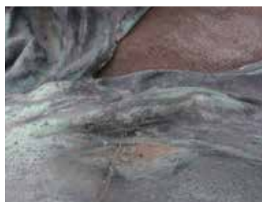
Fig. 9b Fissure après obturation, la zone avoisinante n'a pas encore été traitée à la cire microcristalline (© Metafosel).
