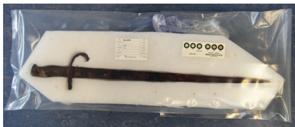
Fig. 21 Une baïonnette en fer dans un emballage sur mesure avec gel de silice et indicateur d'hygrométrie (L. Cognard, MRAH, 2015 © SPRB).
